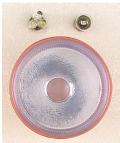
反射板の孔の大きさに合わせて考察すれば、5φのLEDなら3個しか使えません。
