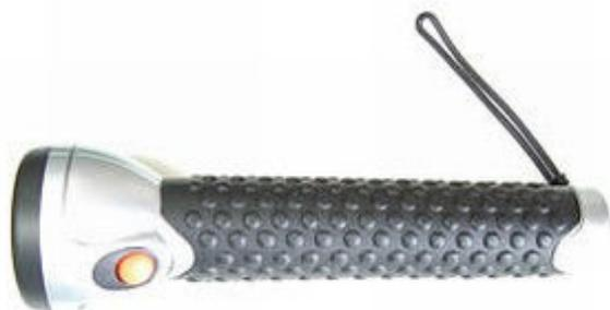
100円で売っている単一電池3本・電球使用の懐中電灯を、白色LED化し、非常用の長時間点灯と、懐中電灯としての実用とを、スイッチで切替えて使えるように考察した。
