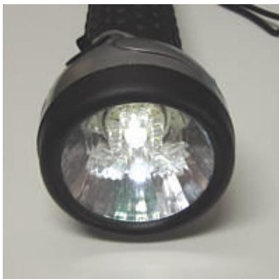
単一電池3本(4.5V)使用のLED式懐中電灯、出来あがりしました。3個100円のマンガン乾電池で実験です
