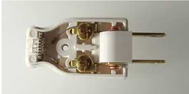
LED2個 AC100V用の常夜灯 ACプラグに内蔵
