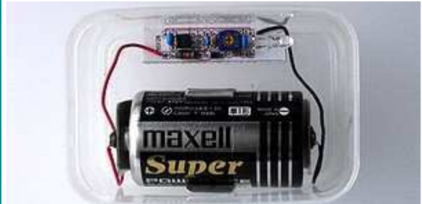
LED1個、単一1本、2mA以下の常夜灯。 1. 5V、3Vのデータ、多数を掲載。
