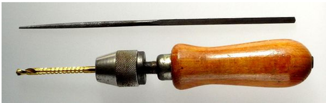
丸ヤスリ、5mmのドリルビットと手廻しハンドル。 このドリルビットは、中央の螺旋状のところで、穴を長方形に加工できます。
