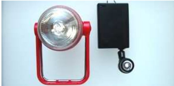
LED1個 中途半端に使った電池の、救済です。連続点灯。
