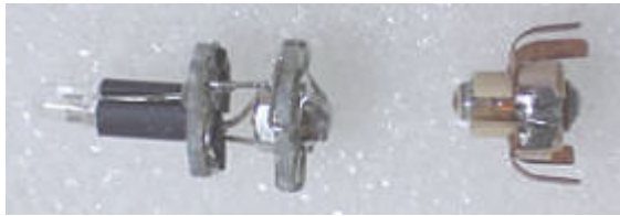
完成したLEDとFETの基板 その右は以前の麦球
