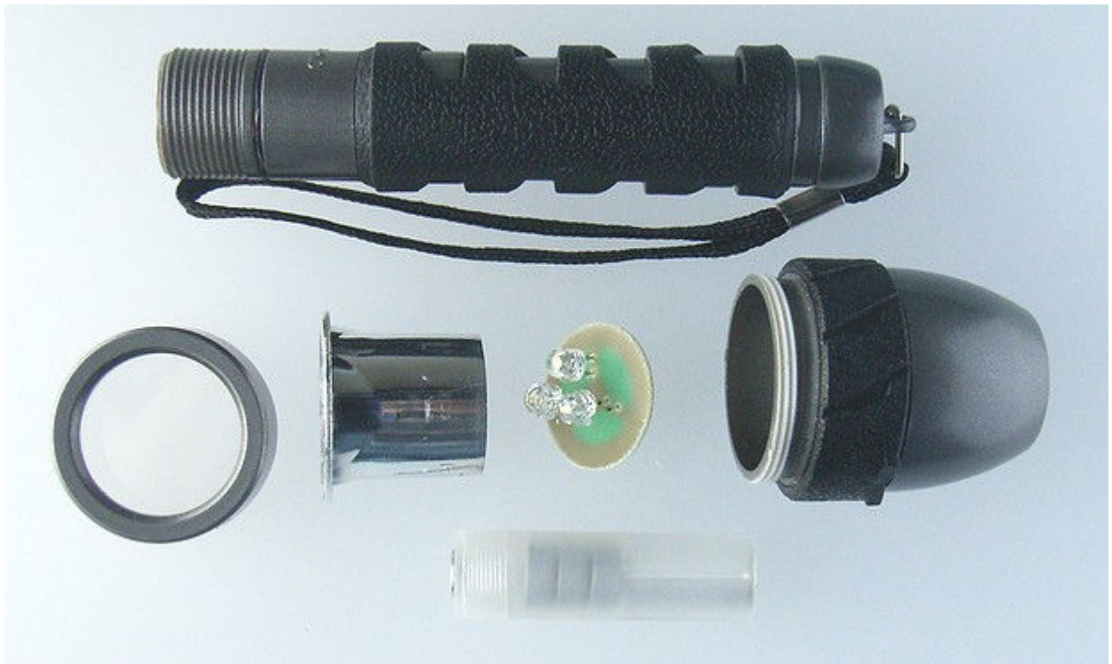
上: 胴体ケース(単三電池2本が入る大きさ) 中: 前部、反射鏡、LEDと基板、頭部カバー 下: 電池ケースに入れたボタン電池(LR44、3個)
