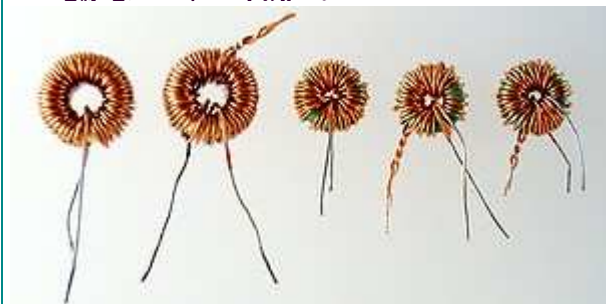
トロイダルコア: 48\mu\text{H} 、 100\mu\text{H} 、LED1個 回路と効率、輝度の降下を比較
