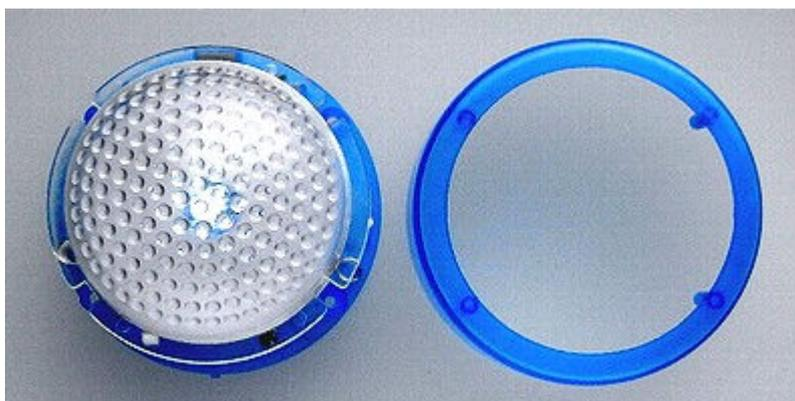
LEDの点灯を確認したら、カバーを載せ、枠をビス止めします。表面の押し下げで点灯、再度の押し下げで消灯を確認します。基板のVRをまわして明るさを調整します。電池カバーをして完成です。
