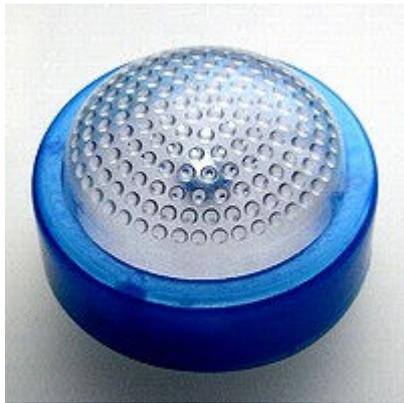
画像左は、径80φ位の、豆電球を単三電池2本で光らせる、壁掛けもしくは卓上用のランプです。100円均一店では2個100円で市販しています。上部のレンズ部を押すとスイッチが入り点灯します。再度押すと断になります。定格は、電池：単三2本使用、電球：2.5V0.3Aです。これに昇電圧回路を組み込み、LEDを単三1本で点灯します。停電時などの非常時にぶつからない程度の明るさを考えています。画像は、完成したもので、点灯しています。
