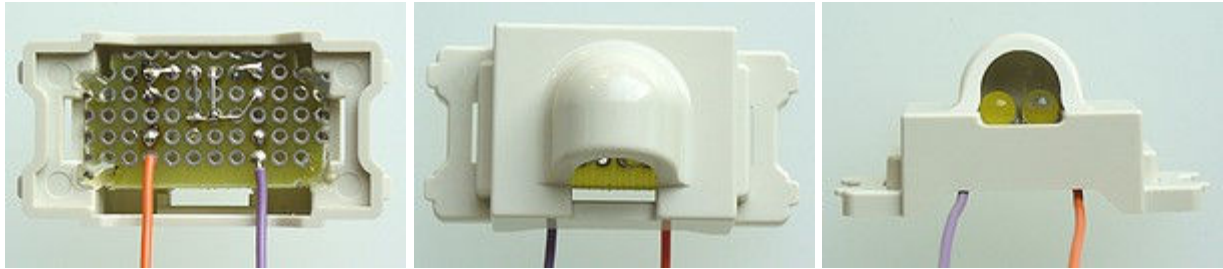
画像左:カバーに固定。 画像中:表側。 画像右:LEDが2個横に並んでいる。
