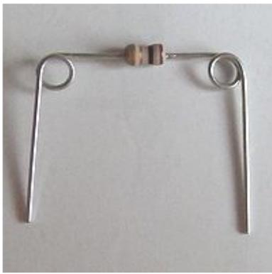
最初に、1オームの抵抗器の足を加工して、テスターのリード棒が入るように加工します。リード棒に巻きつけられれば完成です。画像左の形状に加工します。
