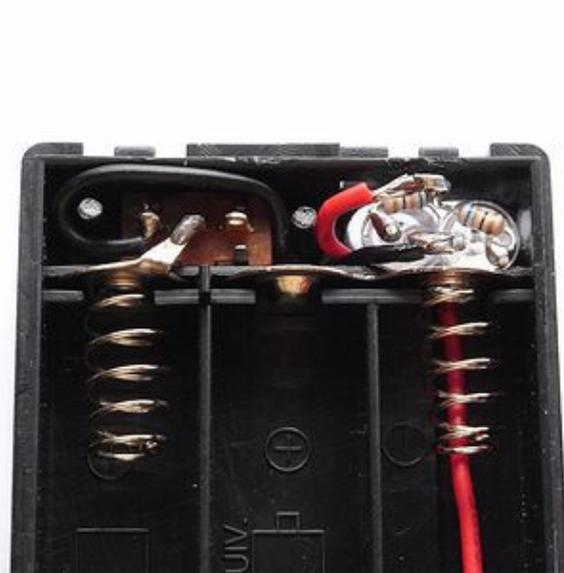
左画像：狭角と広角の2種類のLEDを向き合わせにします。LEDの台座が平らのほうをあわせませす。平らのほうは、電池の一侧に接続します。LEDの十側に、抵抗器を各1個半田し、反対側の線をより合わせませす。
