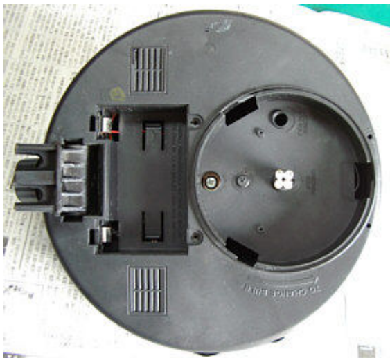
LEDに変更後の発光部、LEDが4個あるのが解る。
