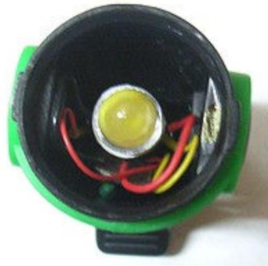
また分解して、10φのLEDに変更します。配線したら、基板を中に押込みます。
