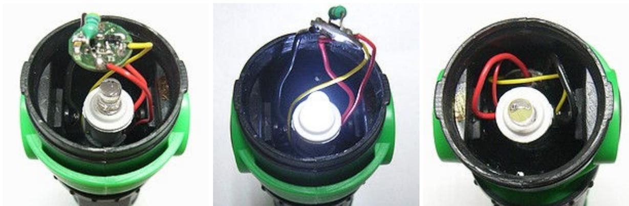
線材をつなげて、点灯を確認し、基板を中へ押し込みます。
