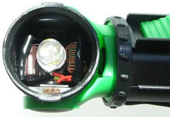
頭部の中へ、組み込み、LEDの位置を調整します。その他の部品もうまく収まるように、周囲に押し込みます。電極に半田した電源線をつなげて、元道理に組み立て完成です。
