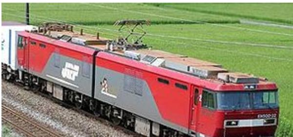
これは、北海道で使われている、EH500型、電気機関車です。車輪はHですから8輪です。2両連結の形態ですが、連結されている状態で運行されます。8輪の機関車はカーブを曲がれませんので、やむを得ず、真ん中でつないでいるのです。貨物列車を引くときの機関車の重量は、引かれる列車の全重量を考えないと引っ張れません。そのため、輸送用の貨物列車用の
