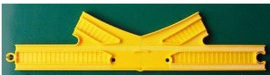
切って短くなったポイント線路。あとは、画像上部の両端の、次のレールの接続部分に孔をあけ、ポイント線路の切り替え用のレバーを、分岐が出来るような形状に加工して 下穴をあけて3mmねじで固定します。
