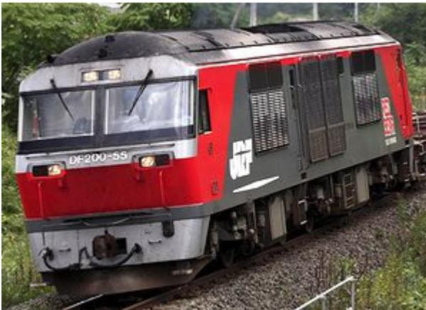
これは、北海道で使われている、DF200型、電気式ディーゼル機関車です。つまり、ディーゼルエンジンで発電機を廻し、その電力でモーターを廻して走ります。
