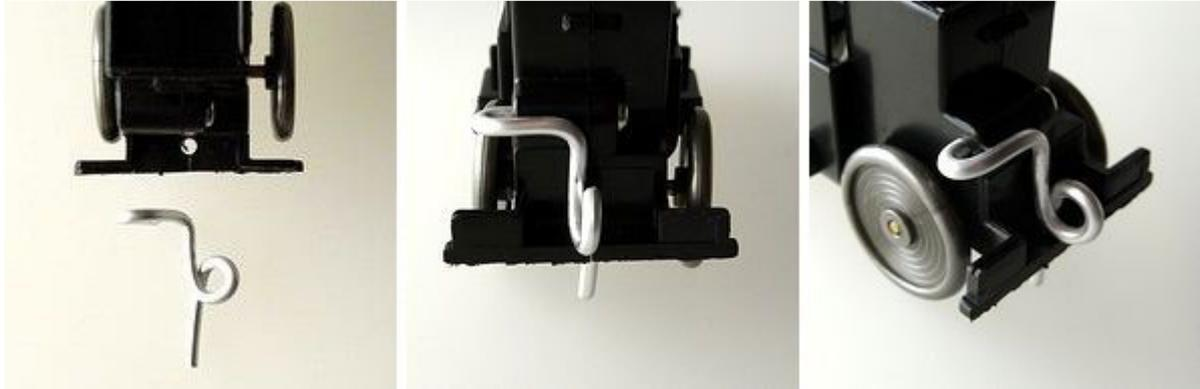
シャーシの連結部に2.2mmφの穴をあけます。直径2mmのアルミ線を加工します。中央より少し外側に丸を作ります。反対側を直角にまげ、今度はU字に曲げます。U字の先を、シャーシのねじ穴のネジのない反対側に入れ、丸の先はシャーシの穴に通します。シャーシの下へ出た部分は切ります。なだめすかしながら変形させてセットします。前後、対称です。
