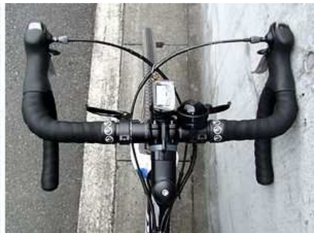
左:レバー位置を外側に5mm移動、左側のレバー下の文字が良く見える 右:移動前
