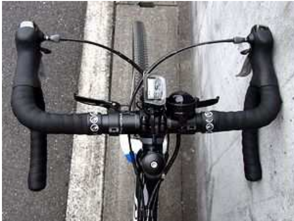
左:ステム60mmでハンドルが近くなった。 右:変更前、80mm。
