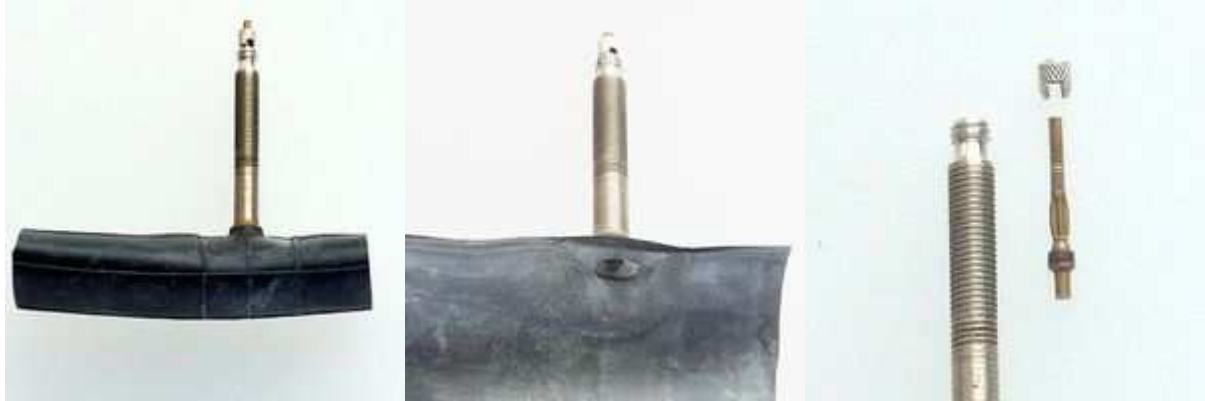
左: 外観。 中: チューブの内側部分。チューブと一体化している。 右: バルブの構成部品。
