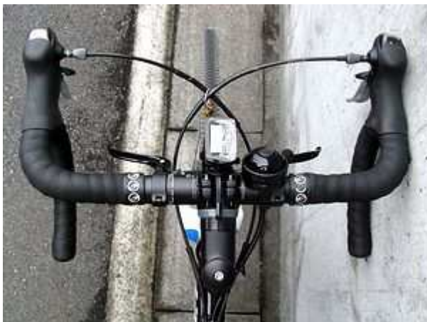
左:レバー位置を外側に5mm移動、左側のレバー下の文字が良く見える 右:移動前
