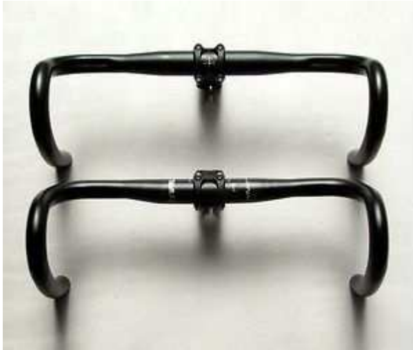
上:新ハンドル、ドロップ120mmとステム60mm 下:旧ハンドル、ドロップ130mmとステム50mm
