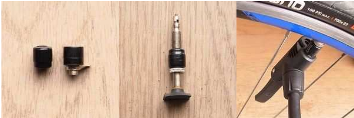
左: 製作したアダプタ(右の電子部品から拝借) 中: 取り付けした状態。 右: 空気を入れている状態。
