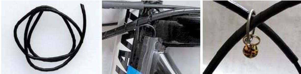
左:スパイラルチューブ。中:メータからの線をブレーキワイヤーと一緒に。右:鈴を変速ワイヤーの交点に。
